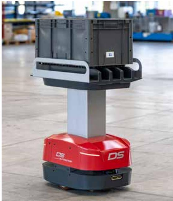
AMY ist durch sein revolutionäres, einfaches Lasthandling vielseitig für den Transport von Kleinmaterial in standardisierten Kleinladungsträgern oder in mehreren kleineren Gebinden einsetzbar.
