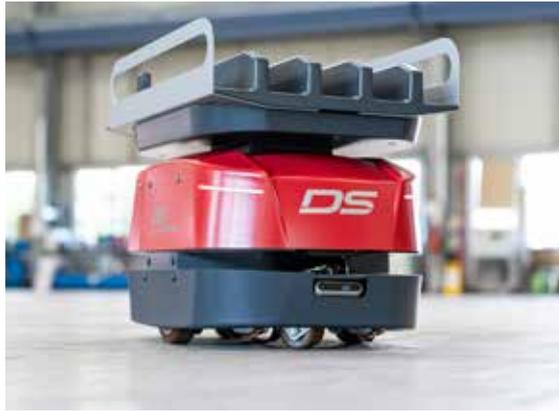
AMY ist der jüngste und kleinste Neuzugang der AMR-Flotte von DS Automotion und für den fahrerlosen Transport kleiner Lasten bis 25 kg ausgelegt.
