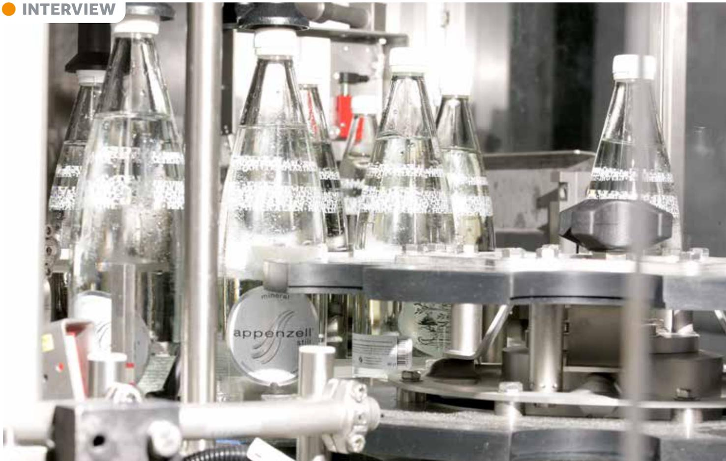
Gefüllt und verschlossen werden die Glasflaschen mit dem Etikett versehen.
