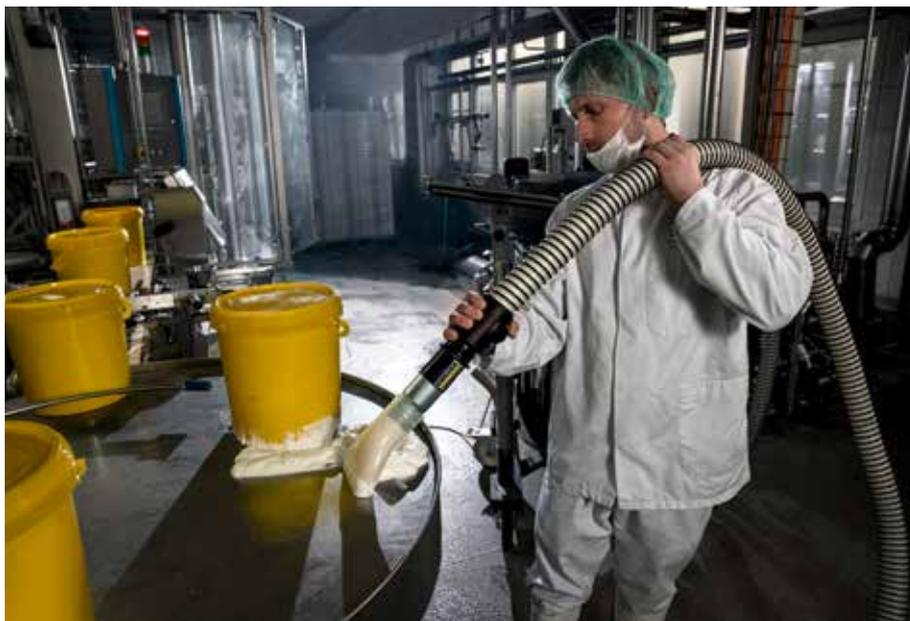
Neben in die Produktion integrierten Absauganlage helfen Industriesauger beispielsweise überschüssige Flüssigkeiten rückstandslos aufzunehmen. KÄRCHER
