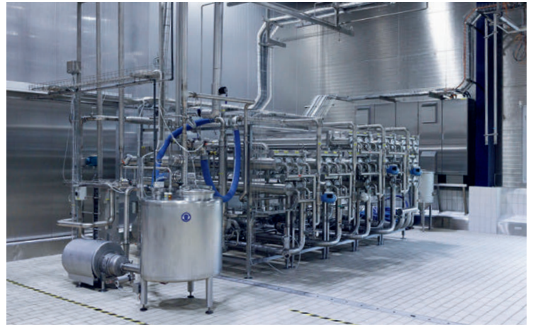
Ultrafiltrationsanlage zur Aufreinigung der nativen Hefeproteine für innovative pflanzliche Food-Rezepturen – die nächste Kapazitätserweiterung ist schon in Planung.
