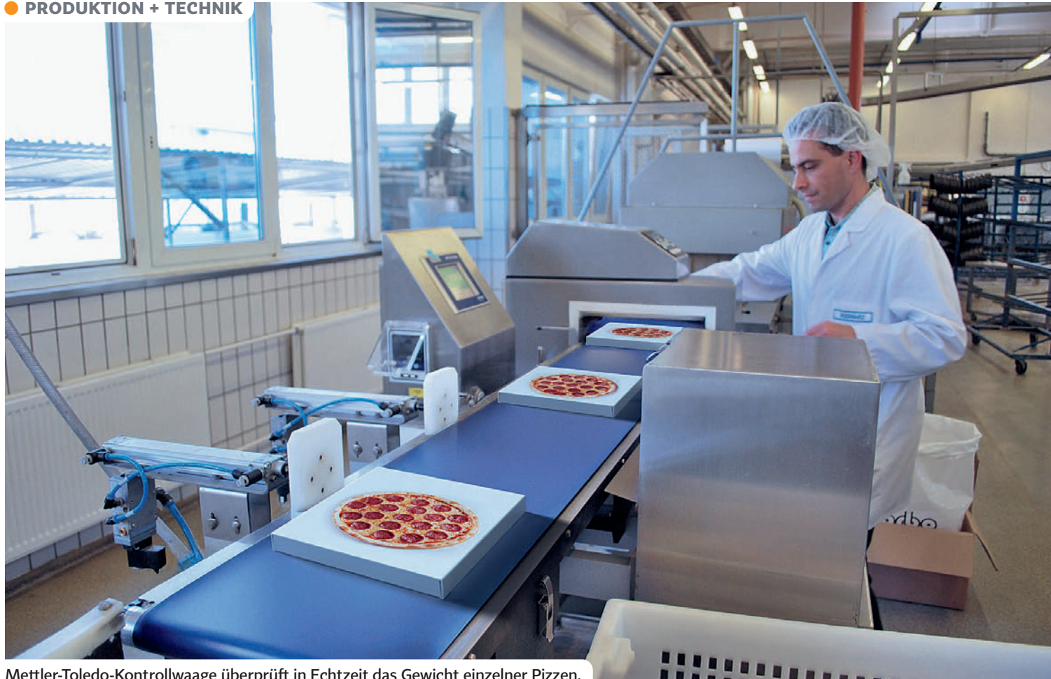
Mettler-Toledo-Kontrollwaage überprüft in Echtzeit das Gewicht einzelner Pizzen.
