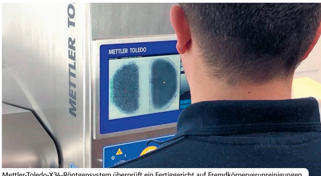
Mettler-Toledo-X34-Röntgensystem überprüft ein Fertiggericht auf Fremdkörperverunreinigungen.
