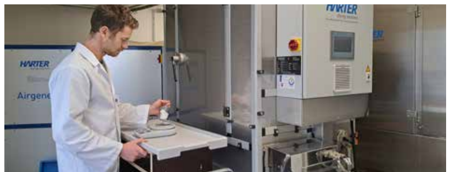
Im Technikum bei Harter werden Produkte auf Machbarkeit und ihre Trocknungseigenschaften hin getestet – hier grobkristallines Speisesalz. Verschiedene Trockner stehen für die Versuche zur Verfügung. HARTER GMBH
