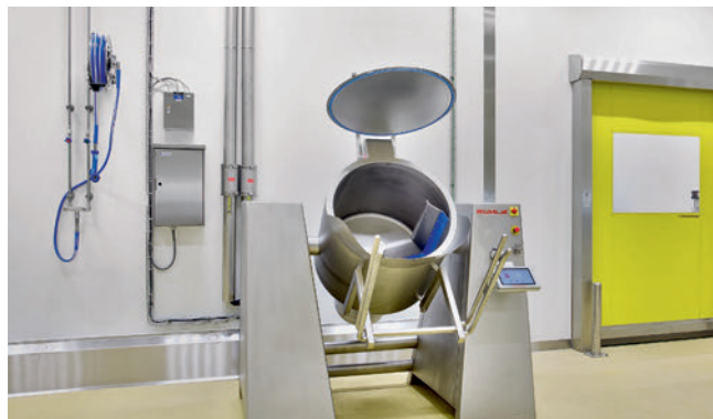
Mit dem 300-Liter-Röhle-Feinkostmischer können unter Vakuum im auf 2°C gekühlten Vorgang Massen vermengt werden. Er verfügt über eine CO 2 -Mantelkühlung.
