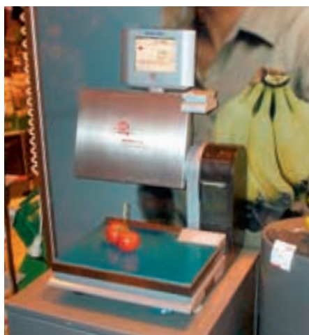
Die Waage erkennt die Tomate über eine Fotozelle und das entsprechende Softwareprogramm.
