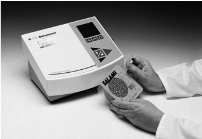
Stichprobenanalysegeräte zum Testen von Verpackungen auf Restsauerstoffgehalt oder Sauerstoff/Kohlendioxid mit Selbstdiagnosefunktion und eingebautem Datenspeicher zur automatischen Erstellung von Testberichten.
