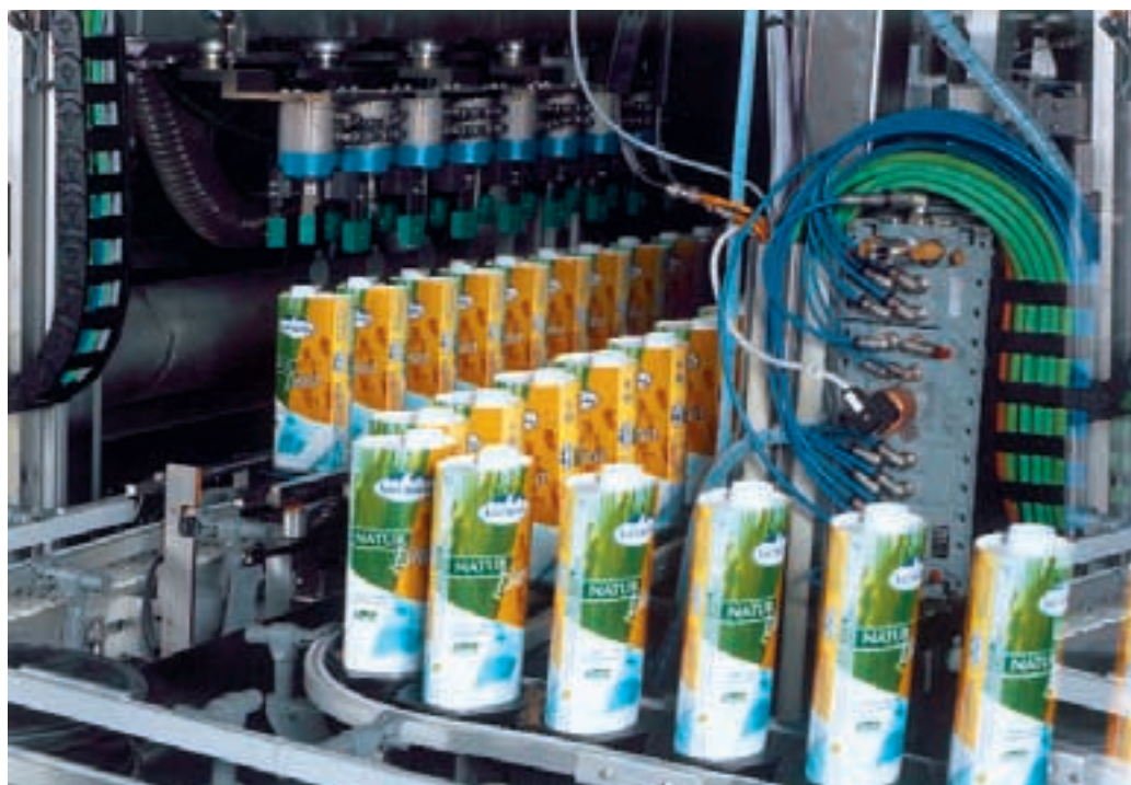
Die Maschine produziert und füllt die Packung in 14 Arbeitsschritten.
